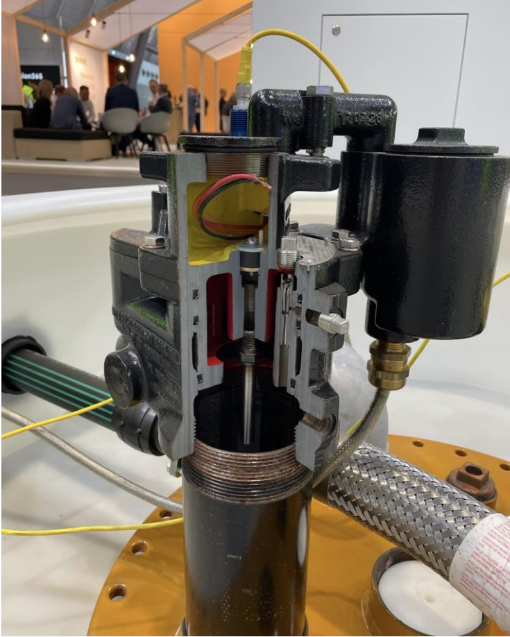
الشكل 7: مقطع تشريحي لرأس مضخة توربينية غاطسة (STP) يوضح مجموعة
